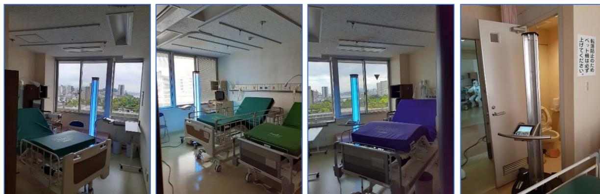
図 7 病室内什器、備品、室内トイレへの UV-C 照射
